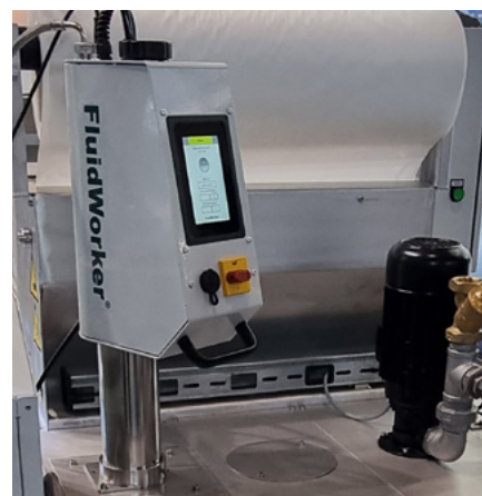
FluidWorker® 50 est installé sur le réservoir de liquide de refroidissement.
